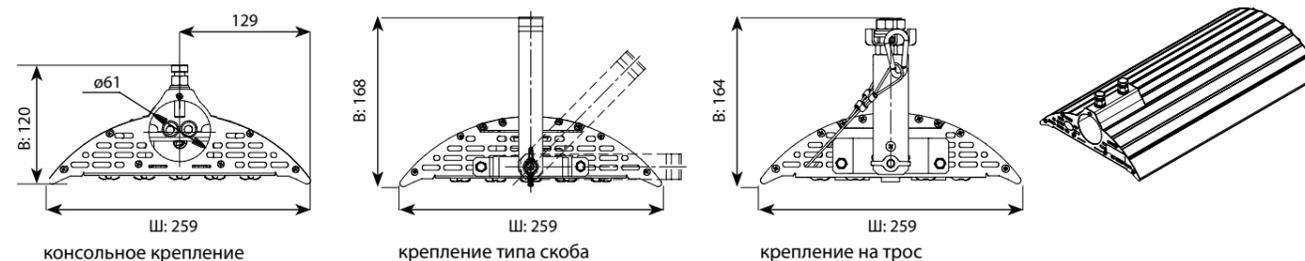
При высоких показателях светового потока, габаритные размеры и вес конструкции гораздо меньше, чем у существующих аналогов. Так же в одном светильнике можно использовать сразу несколько вариантов линз и формировать различные кривые силы света, в том числе и асимметричные. На сегодняшний день данная модель является реальной альтернативой приборам с лампами типа ДНаТ и МГЛ.
